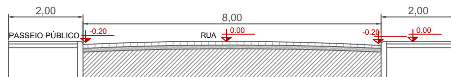
CORTE TRANSVERSAL - RUA ESCALA: 1/100
